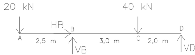
Figura 2 - Convenção das reações de apoio
